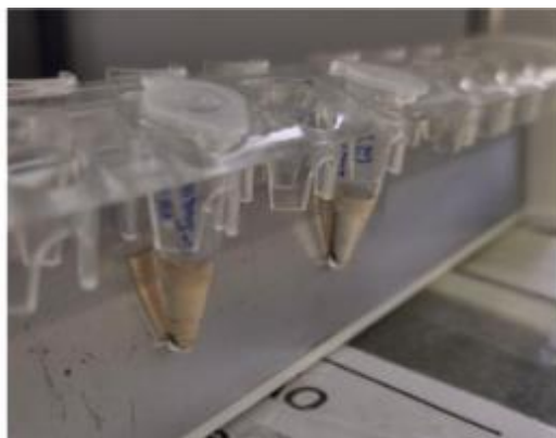
Figura 4: Teste colorimétrico na ferrita de cobalto funcionalizada em PEI. Partícula funcionalizada e controle, respectivamente. Fonte: Autoria própria.
