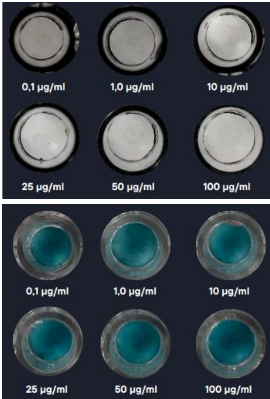
Figura 5 - Ligação antígeno e a ferrita de cobalto com o anticorpo na membrana de nitrocelulose para diferentes concentrações (0.1, 1.0, 10, 25, 50 e 100 µg/ml) sem adição de reagente (I) e com adição do reagente de Bradford (II). Fonte: Autoria própria.
